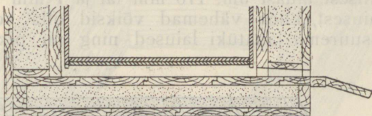
Joon. nr. 11. Ühe põhjaga taru alumise osa pikilõige.
