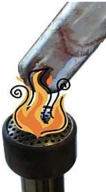
Joonis 15: Paraterfenüüli kristallide kasvatamine gaasifaasist. Paraterfenüül aurustus gaasipõleti leegis ja aurud sublimeerusid kolvis olevale klaaspulgale.
