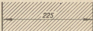
Joon. 83. Mõõtari, kirjutatuna kat- kestamatu mõõtjoone peale. Mõõt- ari kohal on katkestatud viirutus- jooned.
