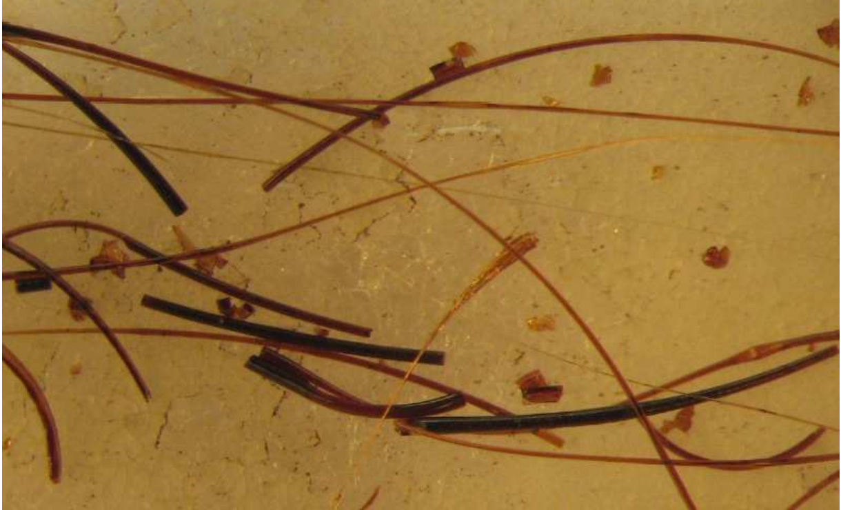
Joonis 26. Tina(IV)propoksiidist tõmmatud fiibrite kuumutamisel kaotasid kõige jämedamad fiibrid (>1,5 mm) läbipaistvuse ning osadesse fiibritesse jäid mustad alad (orgaanilise aine lagunemise jäägid). Kujutise suurendus 2 korda.
