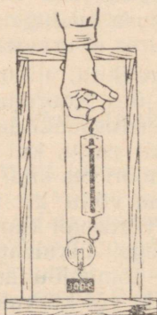
Joon. 77. Liikuv plokk võimaldab võita jõus kaks korda.
