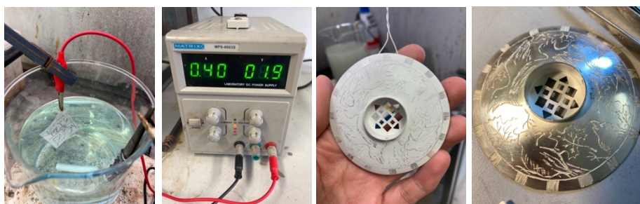
Joonis 31. Pinnakaunistuse söövitamise protsess
