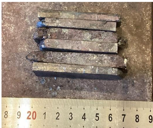
Joonis 10. Esimene pakett toorraua detailidest
