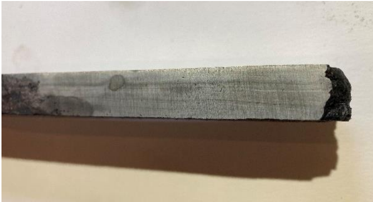
Joonis 19. 20-kihiline separaua pakett.
