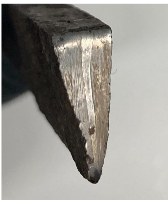
Joonis 20. Teras kihi kulgemine läbi tera ja kihiline küljematerjal
