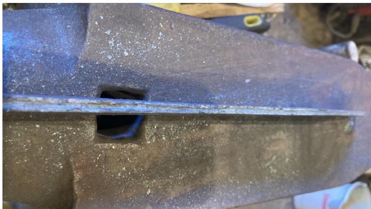
Joonis 32. Lõiketera poolne serv. Süsinikterase vagu tera keskel
