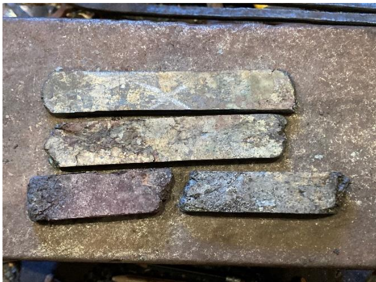
Joonis 9. Esimeseks kokkukeetmiseks tihendatud detailid
