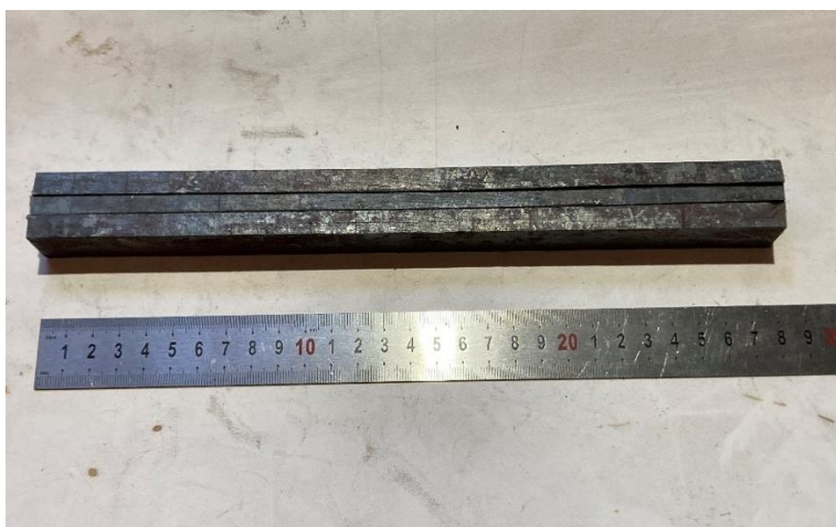
Joonis 36. Kolmas kolmekihine pakett
