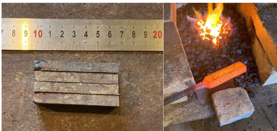
Joonis 12. Teine pakett enne ja pärast kokkukeetmist
