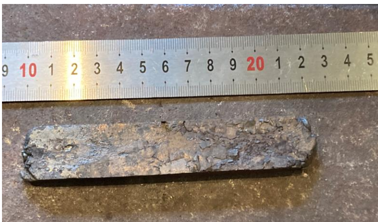
Joonis 7. Latiks tihendatud käsraua tükk
