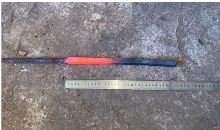
Joonis 31. Astmeliselt keedetud pakett enne venitamist
