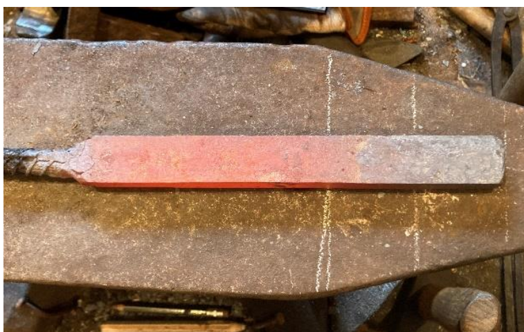
Joonis 13. Latiks venitatud toorraud
