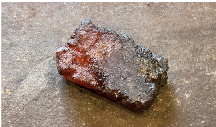
Joonis 6. Esmaselt tihedaks löödud käsraua tükk
