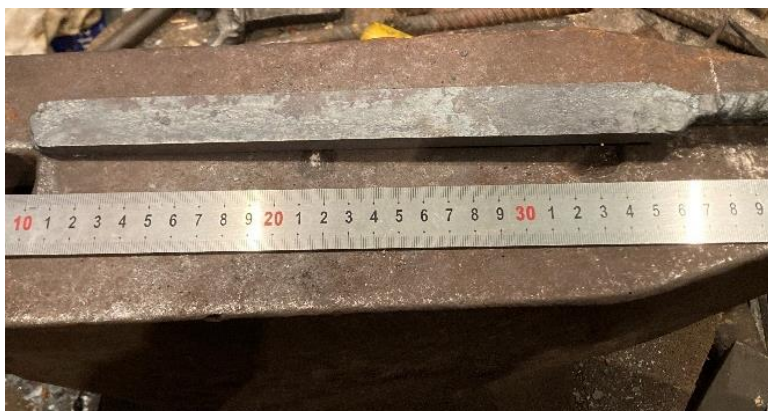
Joonis 11. Esimest korda kokku keedetud latt.
