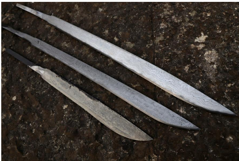
Joonis 40. Kõik kolm sepistatud tera. Foto R. Saage
