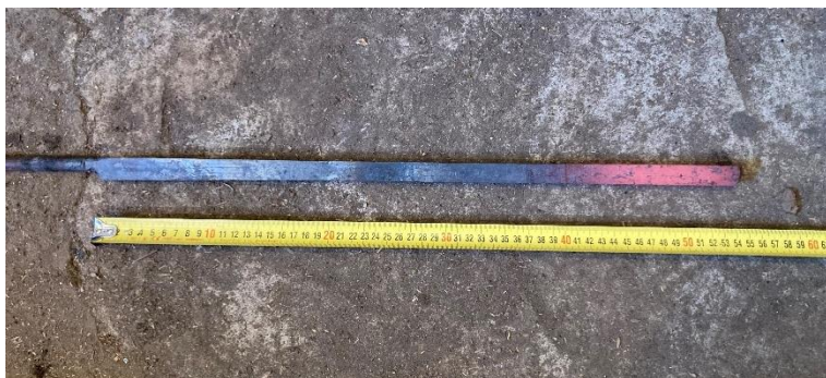
Joonis 28. Vana separaua venitatud pakettlatt
