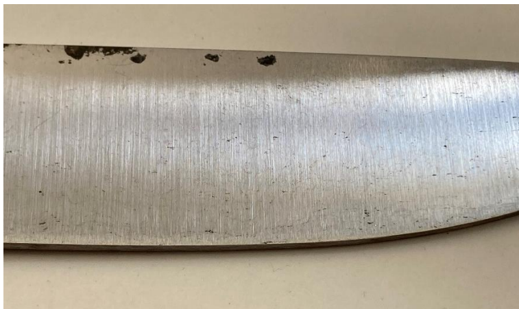
Joonis 26. Šlakipesakeste read
