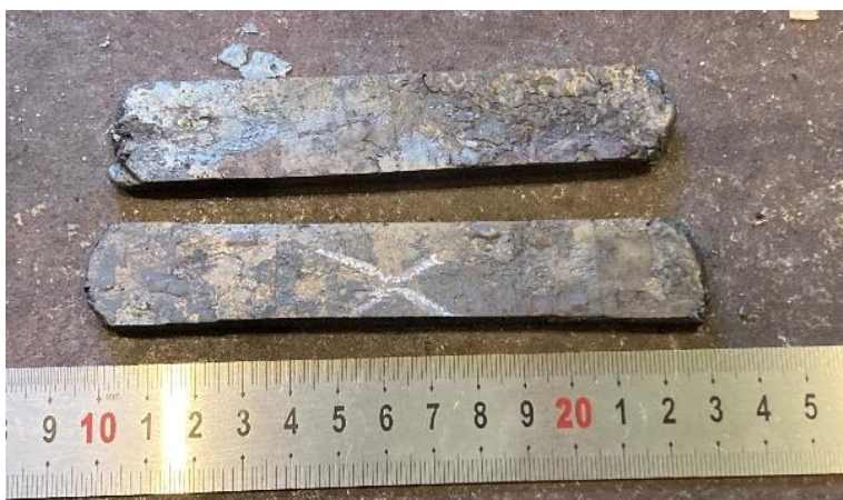
Joonis 8. Kaks esimest toorraua latti. Ristiga märgitud detail nr 2
