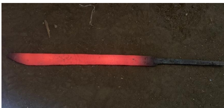
Joonis 33. Normaliseerimine pärast sepistamist
