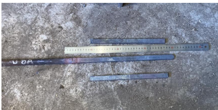
Joonis 29. Pikema terapaketi toorikud enne keetmist
