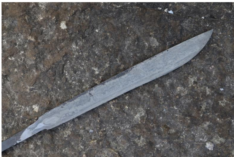
Joonis 27. Söövitatud tera. Foto R. Saage
