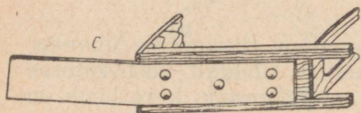
Joonis 148. Keelte kinnitus tiiva talaga: A) ja B) — puust keelte kinnitus, C) alumiiniumist keele kinnitus.
