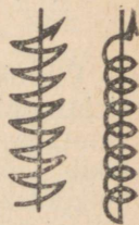
Joon. 32. Elektroodi liikumise skeemid gaasikeevitamisel ja pealesulatamisel
