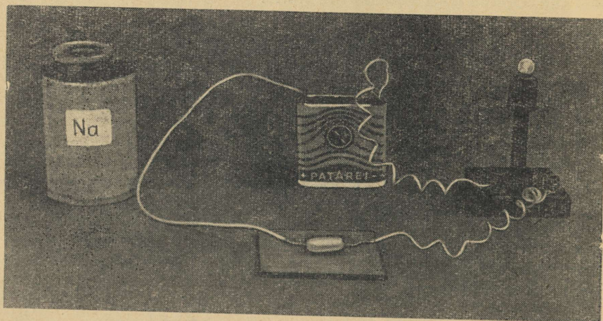
Joonis 12. Naatriumi elektrijuhtivuse demonstreerimine.
