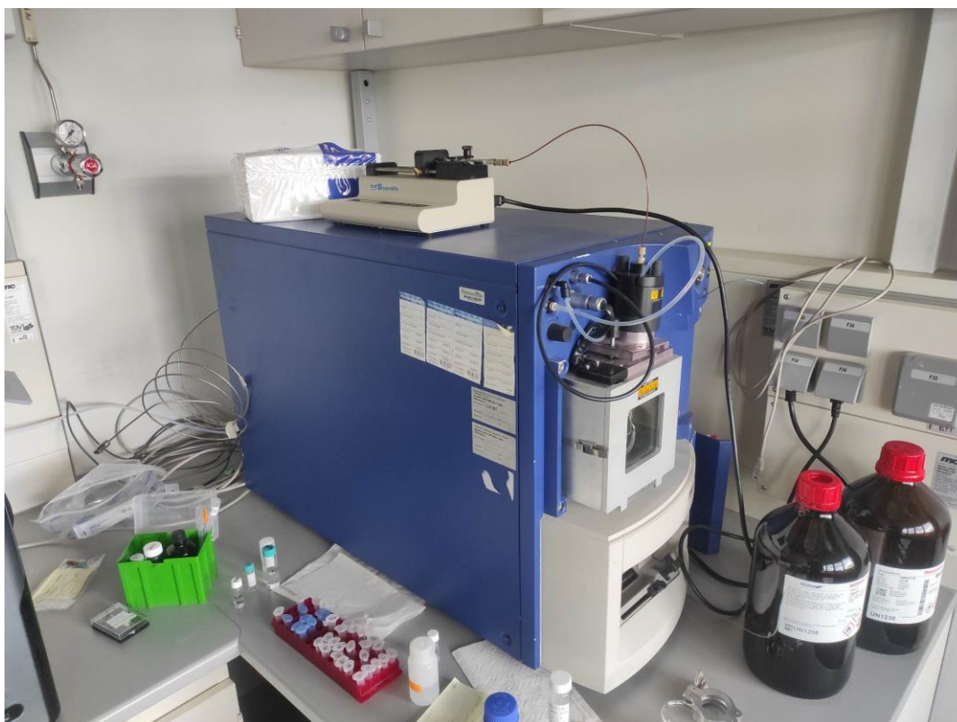
Joonis 4. Töös kasutatud massispektromeeter MassLynx Quattro micro API Mass Spec.
