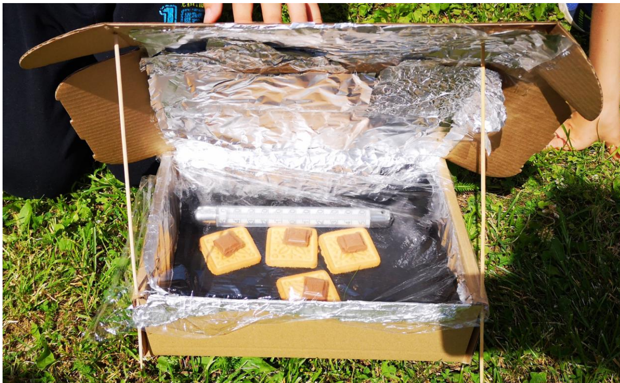
Joonis 1. Näide valminud päikeseahjust
