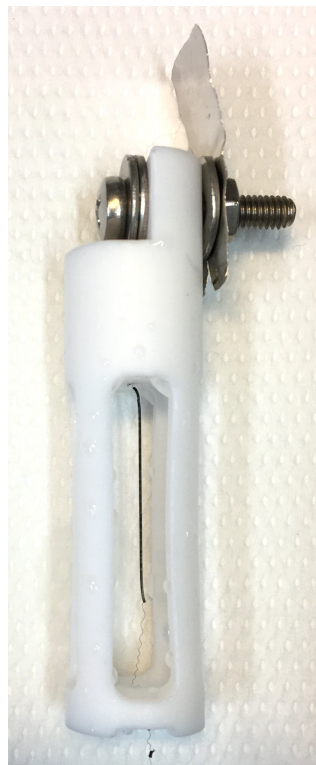
JOONIS 3.12: Silinderraku teflonraami peale ei sadene PPy. Samuti on kinnitamine seibide, poldi, mutri ning kiiluga lihtne.
