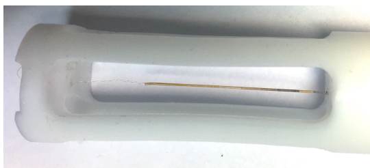
JOONIS 22: Vedru peaks olema ühtlaselt kuldne, kuid on märgata tumedat ala vedru ülemisel poolel.
