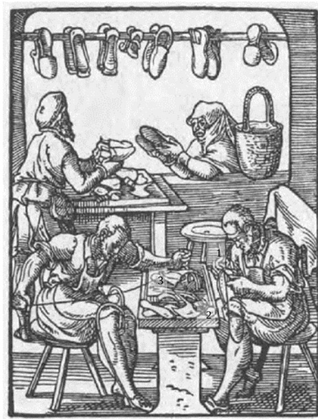
Joonis 13. J. Ammani ja H. Sachi kujutus kingsepa töökojast. 1-naaskel, 2-lõikenuga, 3-tallaserva lõikenuga. Allikas: (Amman, J. & Sach, H., 1568)
