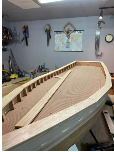
Foto 18. Mudelile reelingulati ehitamine, Siim Rikker
