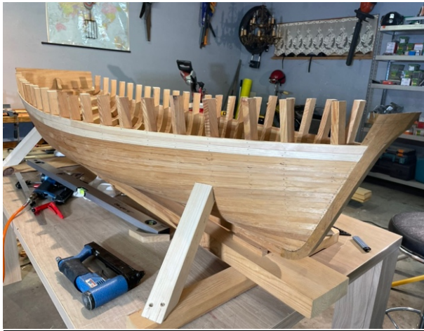
Foto 17. Laevamudeli kereplankude paigaldamine tiiftipüstoli abil, Siim Rikker
