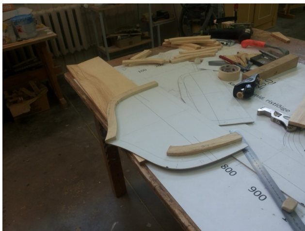
Foto 9. Mudeli kaar. Laeva kuju ja vormi hoidva detaili žabloobi järgi välja lõikamine, Siim Rikker
