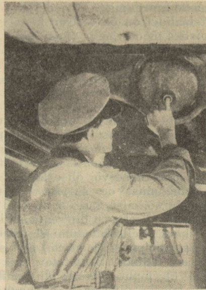
Joonis 94. Diferentsiaali õlitaseme katsumine sõrmega.
