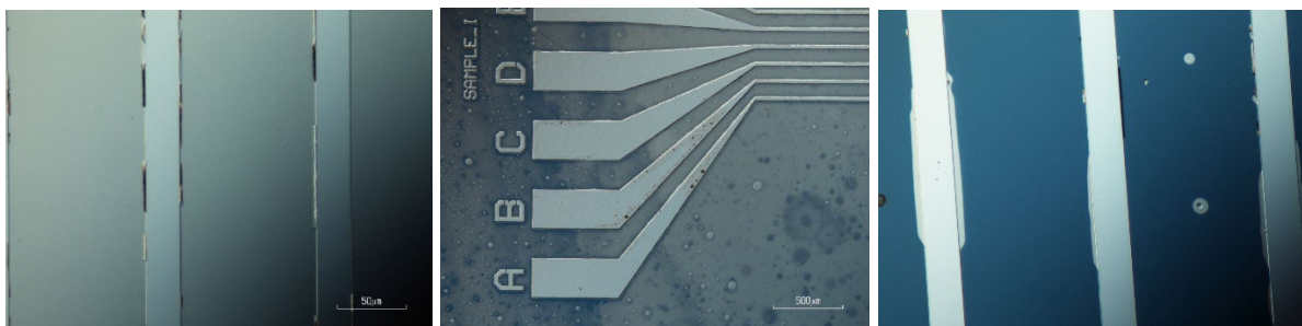
Lisa 3. Söövitamata Si/SiO 2 /Ru/Al struktuuri pind (vasakul), poolsöövitatud (keskel), korralik söövitusprouss tehtud (paremal). Skaala (alustades vasakult) 50, 500 ja 50 mikromeetrit.
