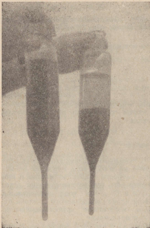
Рис. 10. Вода из окислительного канала до и после отстаивания.
