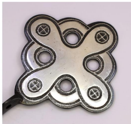
Joonis 23. Soonde taušeerimise kasutamine koos (1a) pinna taušeerimisega (2b). Esiteks graveeritakse sooned, mis moodustavad mustri kontuurjoone. Väikse meisliga raiutakse sooned altpoolt laiemaks. Ülejäänud pinda rihveldatakse noaga. Sooned täideakse hõbetraadiga ja ülejäänud pind taušeeritakse, kasutades katvat pinnale taušeerimist. Foto: Edvards Puciriuss .
