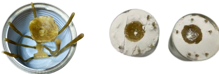
Joonis 15. Vahamudeli paigutamine purki ja kipsist vormid (autori fotod)
