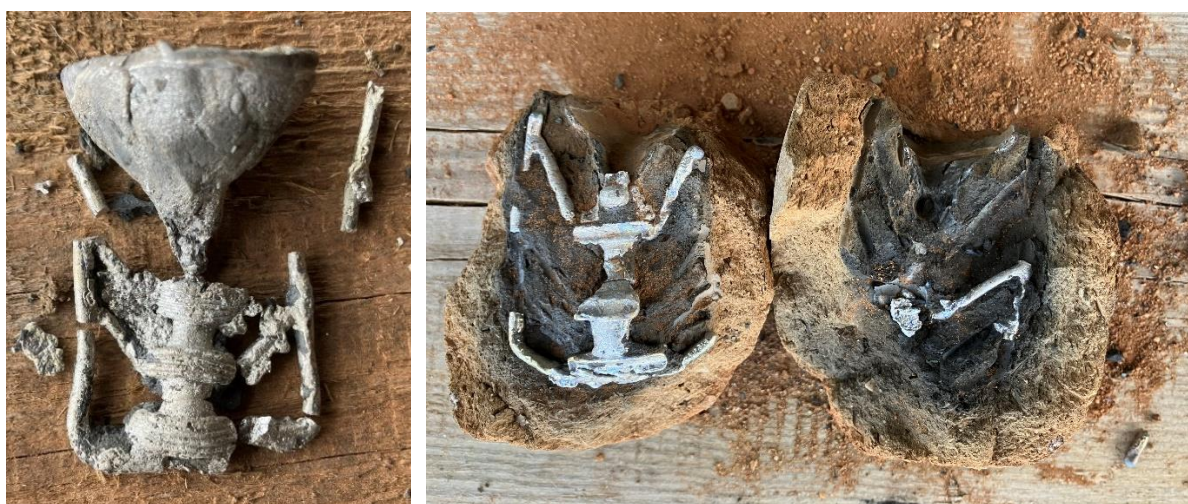
Joonis 26. Liiga haprast materjalist valatud sõled (autori fotod)
