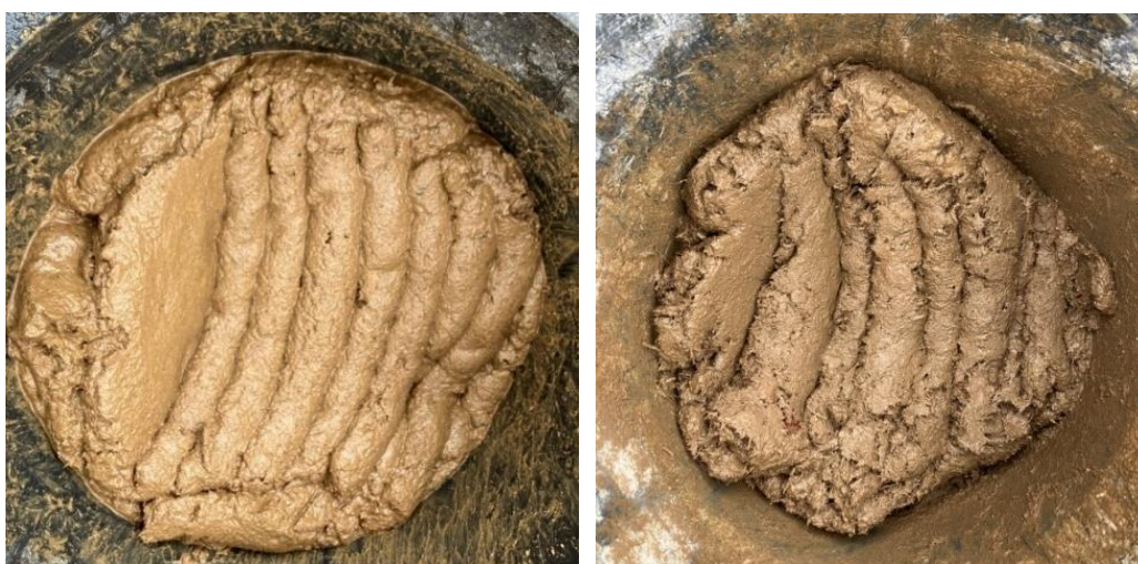
Joonis 18. Vormi segud põdra ja hobuse sõnnikuga (autori fotod)
