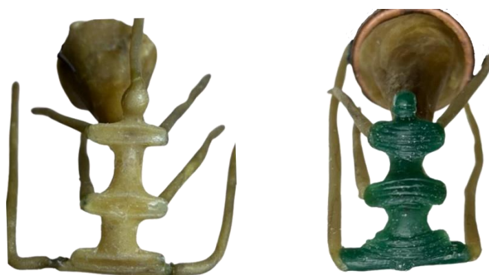
Joonis 14. Vahamudelid koos valu- ja õhukanalitega (autori fotod)
