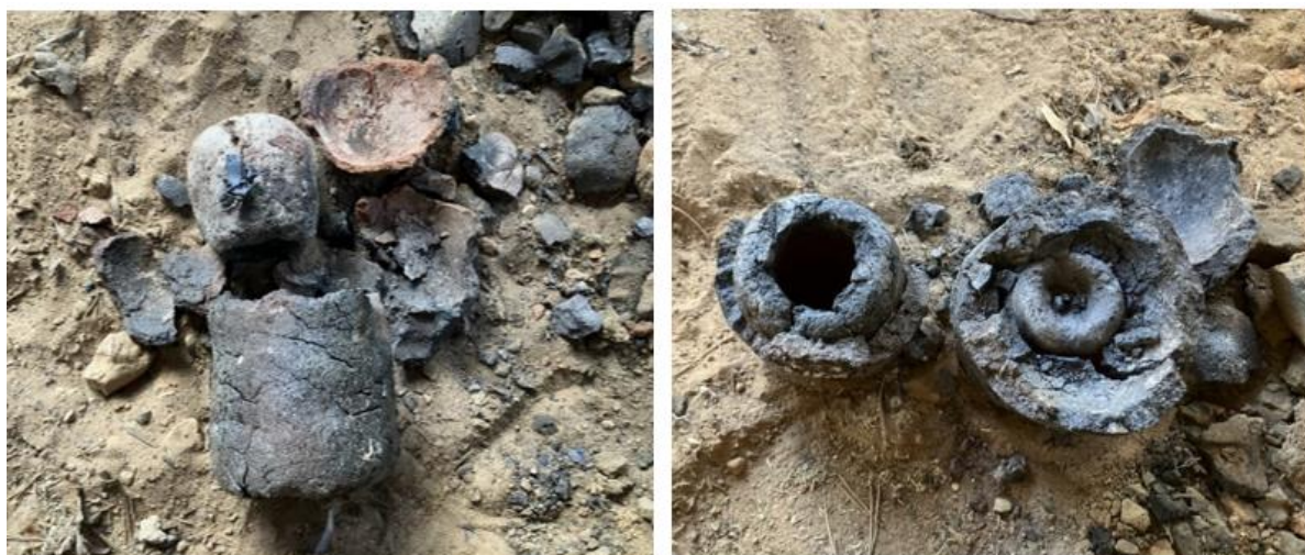
Joonis 32. Vormi lõhkumisel eraldusid tükid kihtide kaupa (autori fotod)
