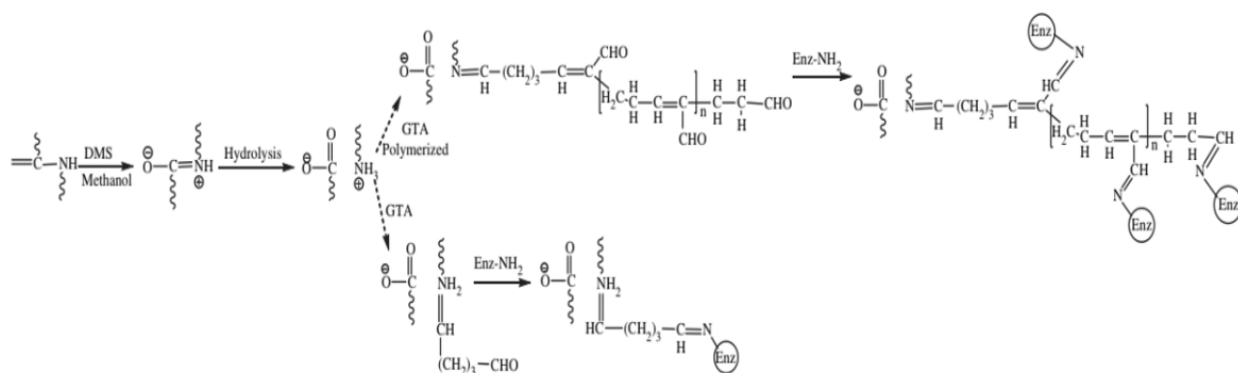
Joonis 3. Tsellulaasi immobiliseerimine tahkele kandjale nailon-6,6 [12]
