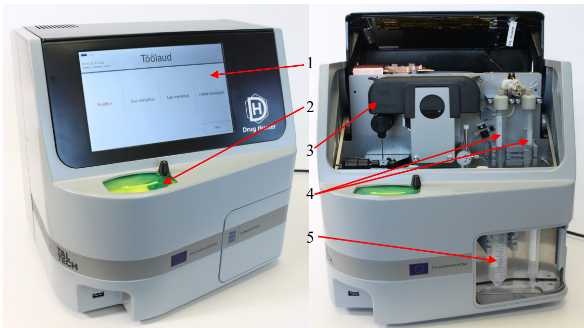
Joonis 6. Tüüpilised seadme kasutamisel manipuleeritavad osad, seade suletud (vasakul) ja avatud luukidega (paremal). (1) puuetundlik ekraan kasutajaliidesega, (2) kapillaari pesuvedelike ja proovi lisamise karussell, (3) kapillaari hoidik, (4) kiibi pesuvedelike anumad, (5) jääkainete kogumisanum
