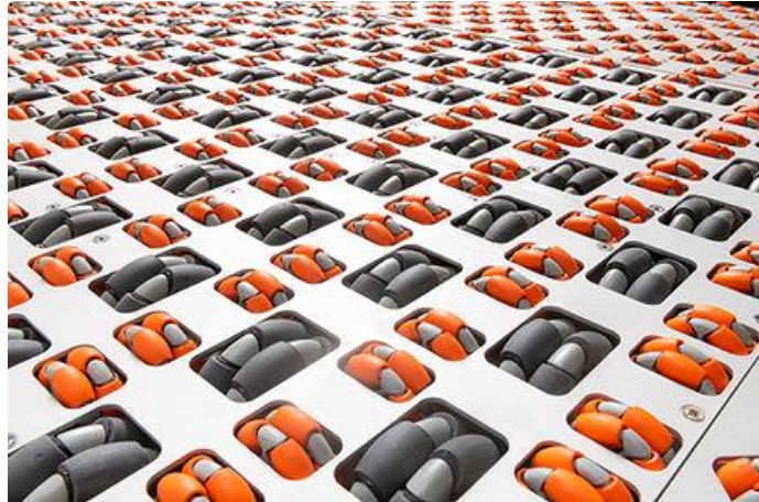
Joonis 2.5. Omniratastega sorteerimislint. [19]
