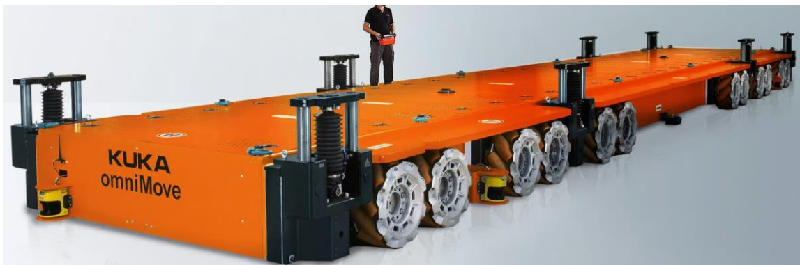
Joonis 2.8. Mekaanumratastega raskete vedude platvorm [24].
