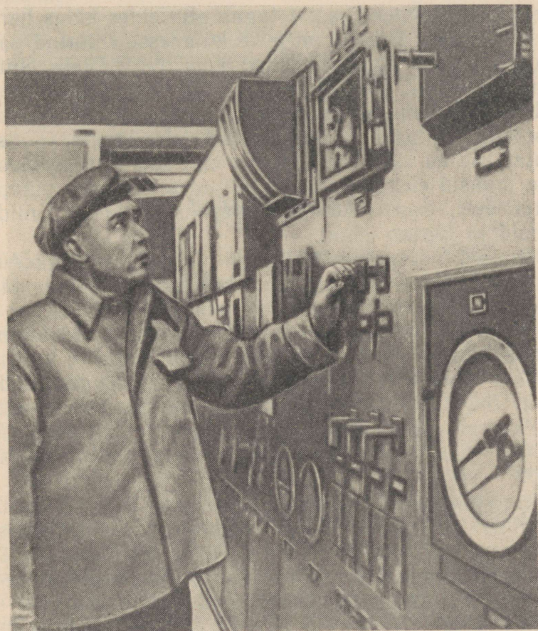
Sellel pildil on tööline, kes üksinda juhib selle määratu suure ahju tööd. Automaadid aitavad töölisel jälgida sulatusahju tööd.
