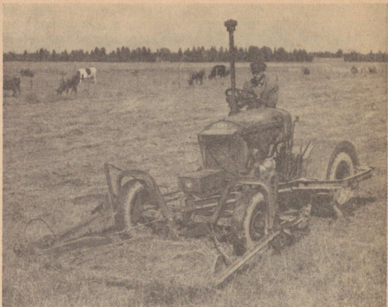
Подкашивание нестравленных остатков травы на долголетних пастбищах самоходной сенокосилкой КС-10.
