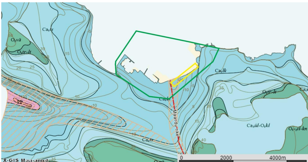
Joonis 2. Uuringuala aluspõhja geoloogiline kaart koos aluspõhja reljeefiga (absoluutkõrgus, m). Kollase joonega on märgitud uuringuala, rohelisega Maardu sadam, punasega Maardu rike ja pruuni viirutusega ürgorg. Maa-ameti geoportaal, geoloogia rakendus.
