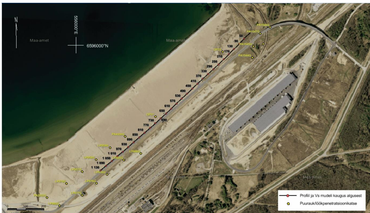
Joonis 6. Seismilise profiili (oranžid täpid) ja töös kasutatud geotehniliste puuraukude ja penetratsioonikatsete (kollased täpid) asukohad.
