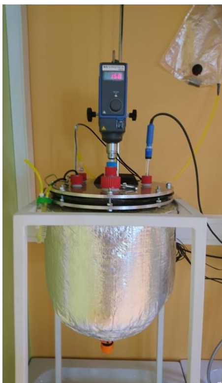
Joonis 8. 20 L reaktor koos sensoritega, segajaga, proovivõtu avaga ja juhtploki. Söötme komponendid, mineraalsed materjalid ja inokulum, mis ettevalmistatud 20 L reaktorikatses jaoks. Arvuti kasutajaliidesega juhtploki opereerimiseks.
