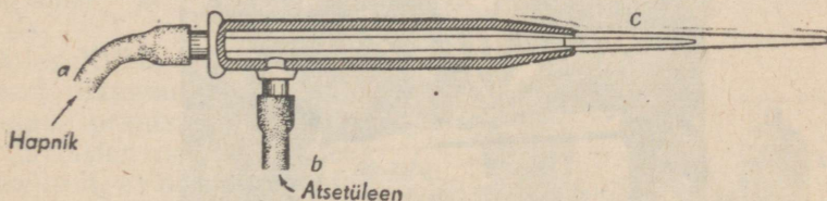
Joon. 18. Atsetüleen-hapnikupõleti skeem:
