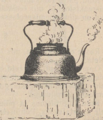
Joon. 25. Vedel õhk keeb jäätükile asetatud teekannus
