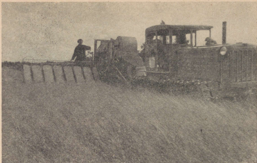
Joon. 80. Linakombaini abil tehakse raske ja aeganõudev linakitkumise töö ruttu ja kerge vaevaga.
