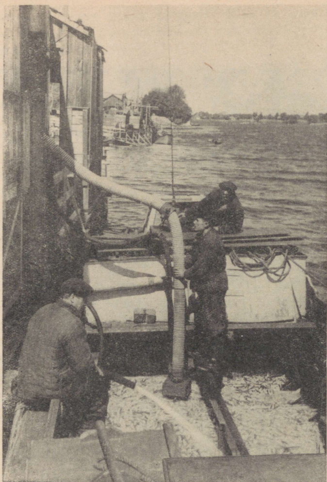
Joon. 63. Kala vastuvõtmine kalapumba abil. Paadis olevatele kaladele lastakse voolikuga vett. Paati on juba ulatatud kalapumba jäme voolik.
