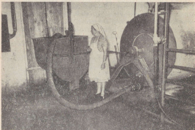
Joonis 2. Pöörlev söötade ettevalmistamise agregaat Pärnu tootmisvalitsuse «Sõpruse» kolhoosis. Agregaat tühjendatakse suruõhu abil.
