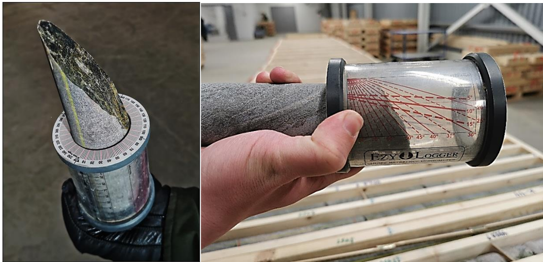
Joonis 5. Lõhepinna kallakussuuna \alpha (vasakul) ja kallakusnurga \beta (paremal) mõõtmine orienteeritud Jõhvi puursüdamikult. Kollane joon vasakpoolsel pildil markeerib orientatsioonijoont ( bottom of hole line ).
