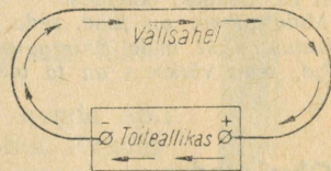
Joonis I. Elektronide liikumine läbi toiteallika ja välisahelas.
