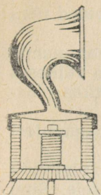
Joonis 98. Elektromagnetilise ruupor- valjuhääldaja ehitus.
