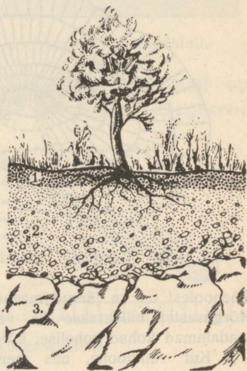
27. joon. Muld ja aluspind: 1. mullakiht, 2. aluspind, 3. sügavamal seisvad kiviliigid — paas, liivakivid jne.
