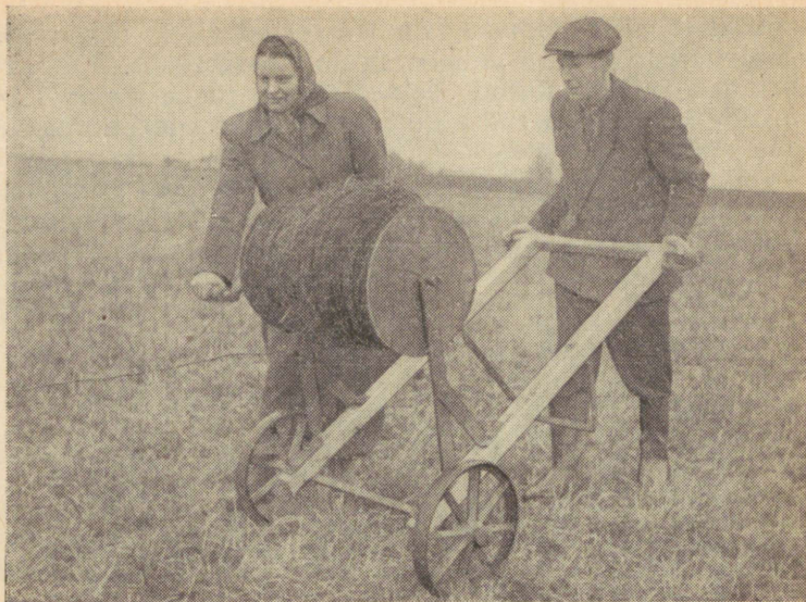
Joonis 38. Käsikäru traadikerimise haspliga (Tähtvere katsebaas).
