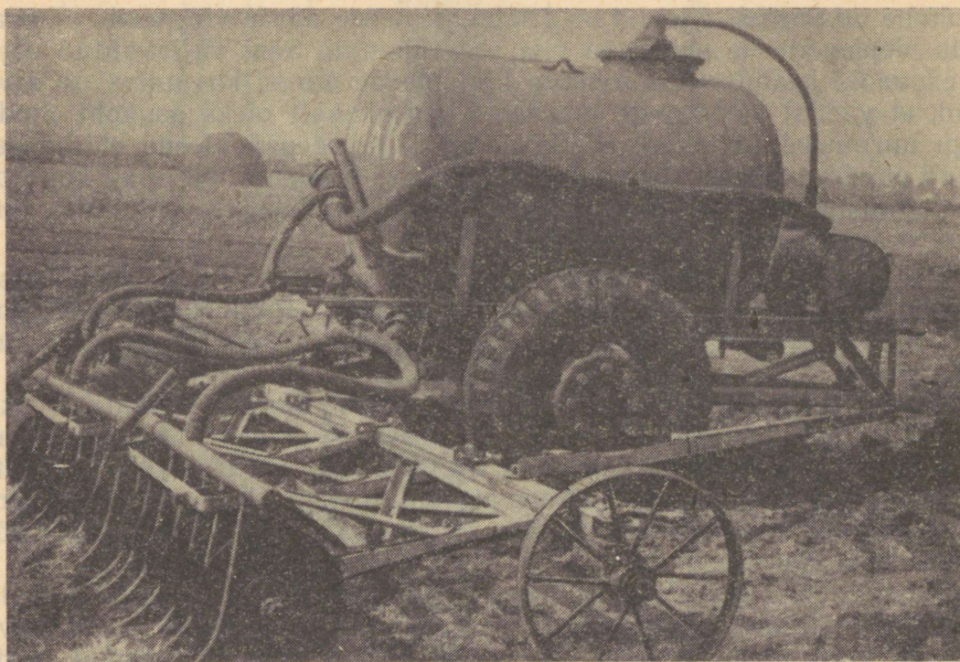
Joonis 6. Ammoniaakvee sisseviimine pinnasesse selleks kohandatud ketaskoorijaga.
