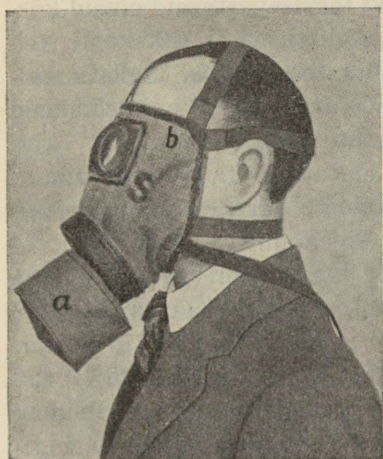
Joon. 150. Gaasitorbik; a — gaasikurn, b — näokate.
