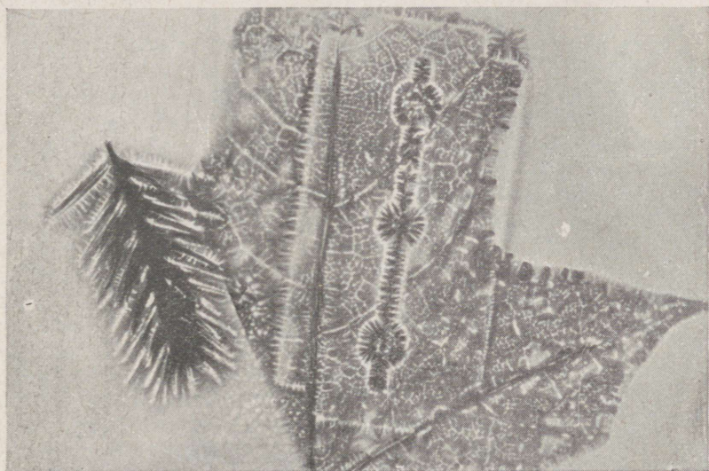
Elektriirgusega fotoplaadi'e fotografeeritud ja sellelt kopeeritud esemed: a — negatiivse pooluse ees, b — positiivse pooluse ees.
