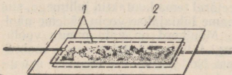
Joon. 224. Kondensaator vilgukivilehtedest isolaatoriga:
