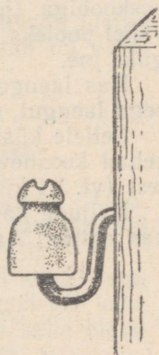
Joon. 97. Portselanisolaator juhtmete kinnitamiseks.
