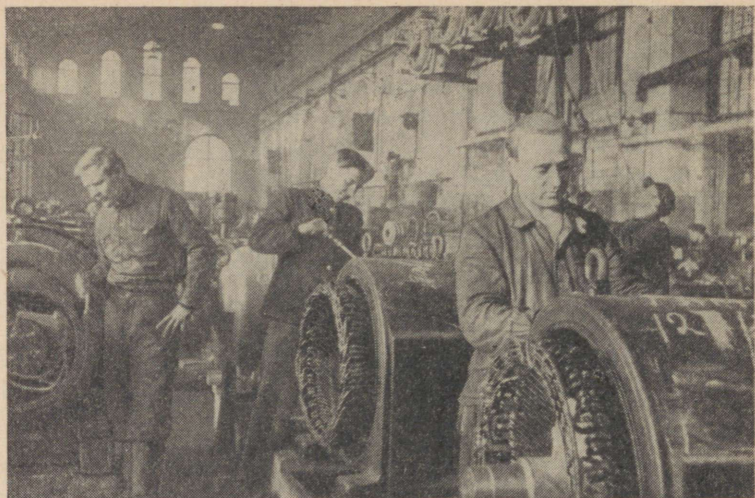
Joon. 43. Võimsate elektrimootorite monteerimine.
