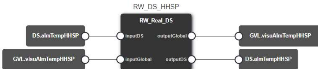
Joonis 7.3. Püsimalu ja globaalse muutuja väärtuste omistamise funktsiooniplokk
