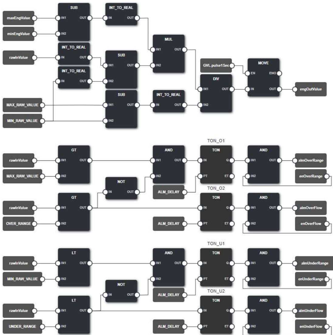
Joonis VII.2. Funktsiooniploki „Scale_AnalogSignal“ programm
