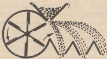
Joon. 137. Tuulamis- ja sorteerimismasina töötamise põhimõtte.
