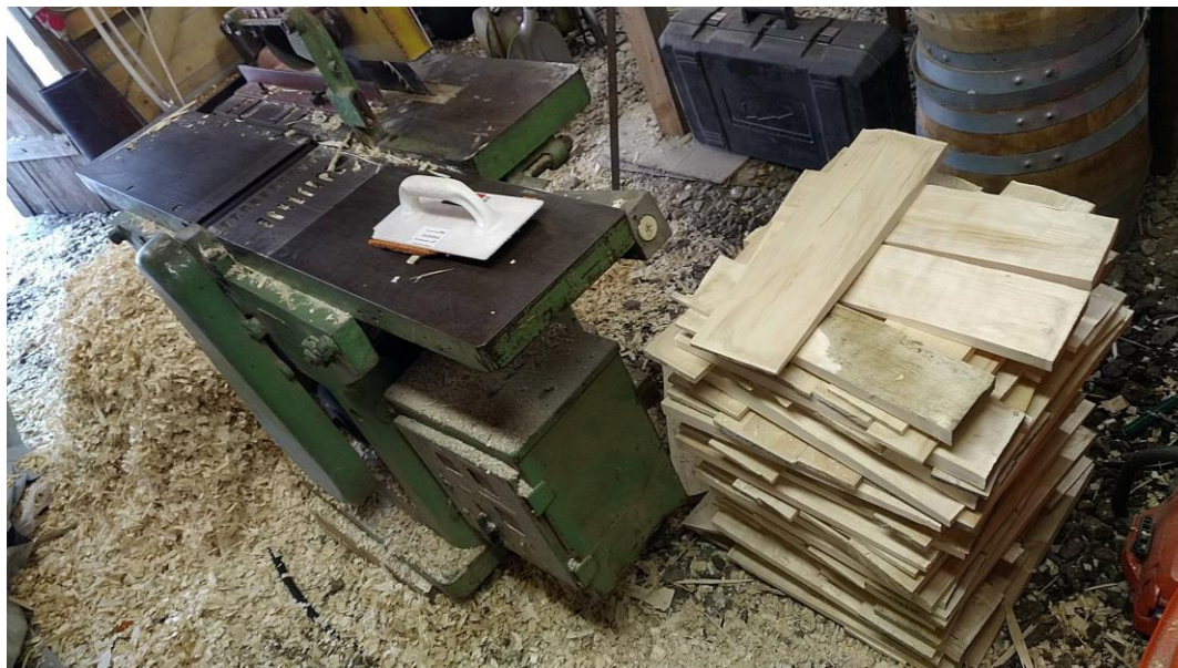
Pilt 20. Rihthöövliga töödeldud katusekimmid (Allikas: töö autori foto)
