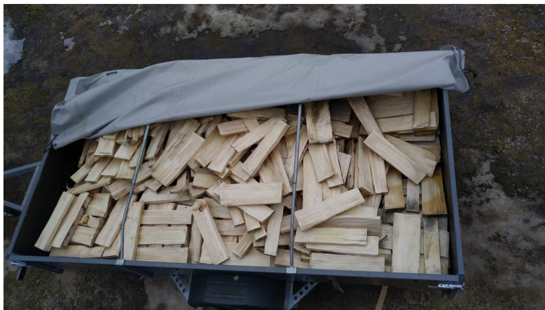
Pilt 19. Lõhestatud katusekimmi toorikud (Allikas: töö autori foto)
