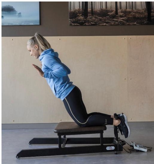
Joonis 2. Reie tagaküljelihaste maksimaalse tahtelise ekstsentrilise kontraktsioonijõu mõõtmise asend spetsiaalsel dünamomeetril (isiklik materjal).
