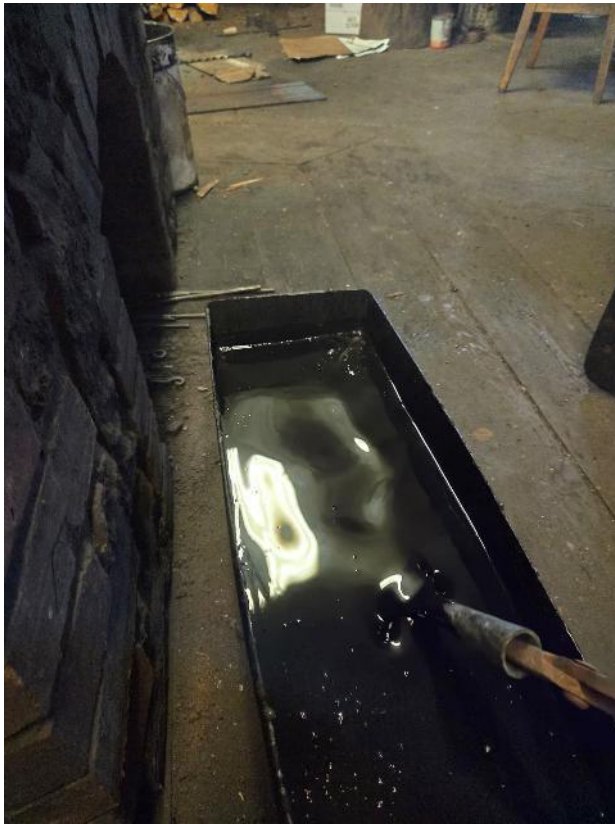
Joonis 32. Jahutamine õlis (foto Mart Parik)
