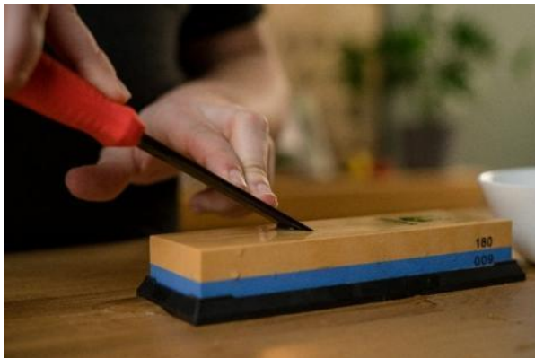
Joonis 16. Peitli teritamine spetsiaalse kiviga.
