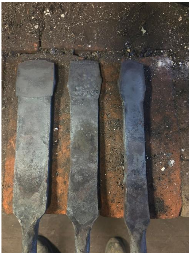
Joonis 29. Lisatud terasega peitlid (foto Mart Parik)
