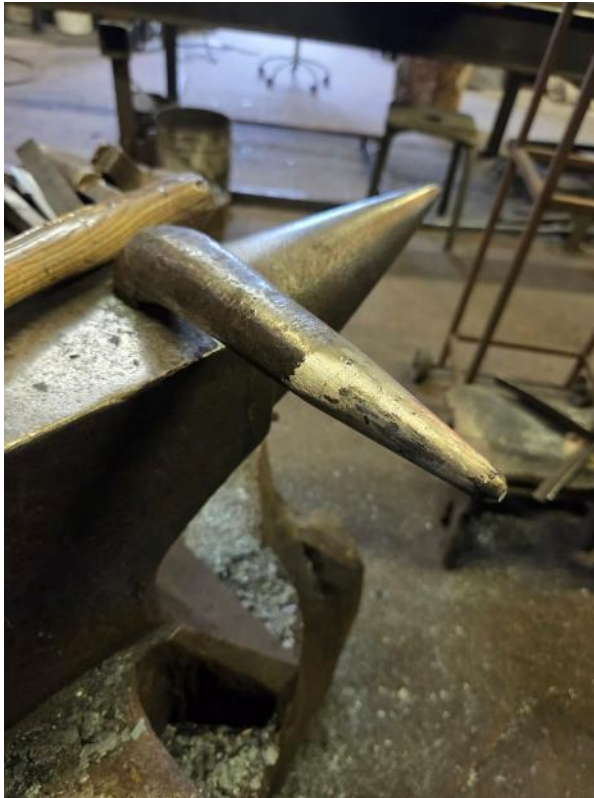
Joonis 21. Alasi ja riigel Reemanni sepikojas (foto Mart Parik)
