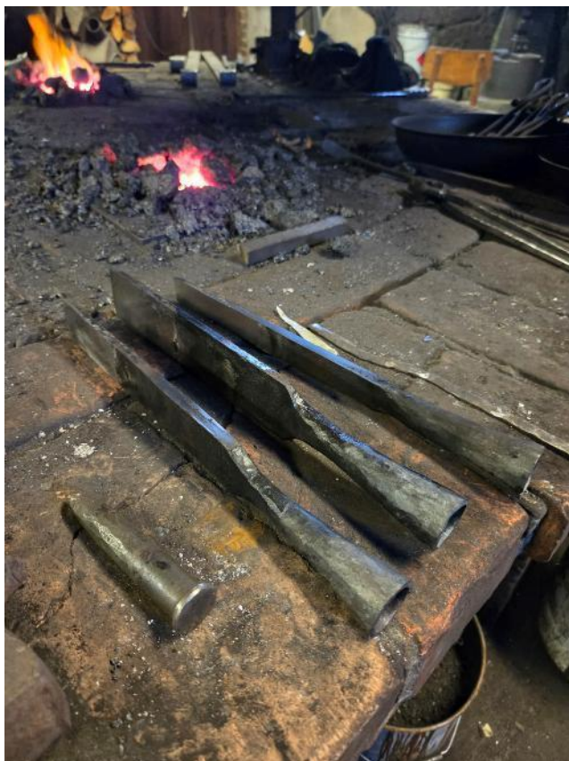
Joonis 33. Peitlid peale karastamist (foto
