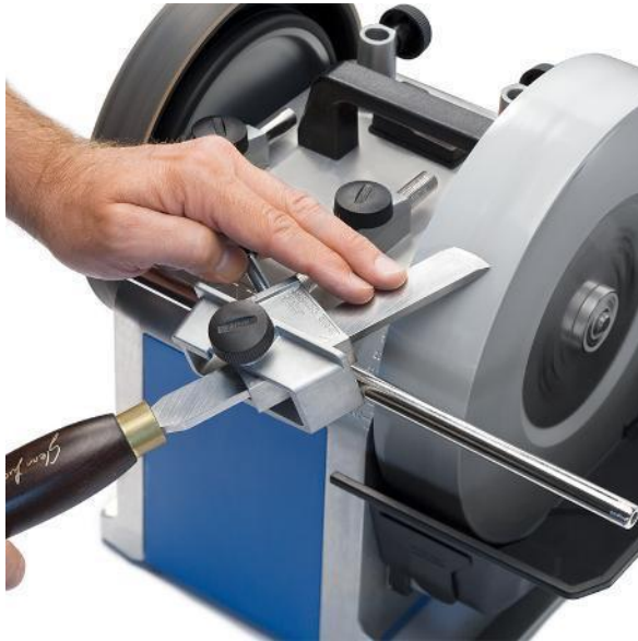
Joonis 15. Õõneslihvimine rakise ja kiviga.
