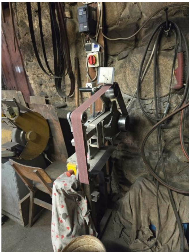
Joonis 22. Lintlihviija Reemanni sepikojas (foto Mart Parik)
