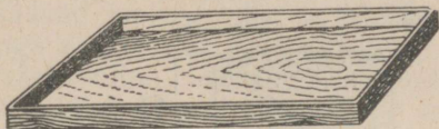
Joonis 28. Kuni 10 päeva vanuste tibude kahepoolne söödakandik. Mõõdud: pikkus 70 sentimeetrit, laius 30 sentimeetrit ja kõrgus 4 sentimeetrit.
