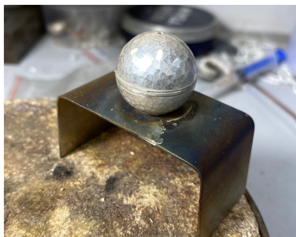
Joonis 23. Haamrilöökidega viimistletud krõllile sai vitsale toetuseks joodetud vahevöö.
