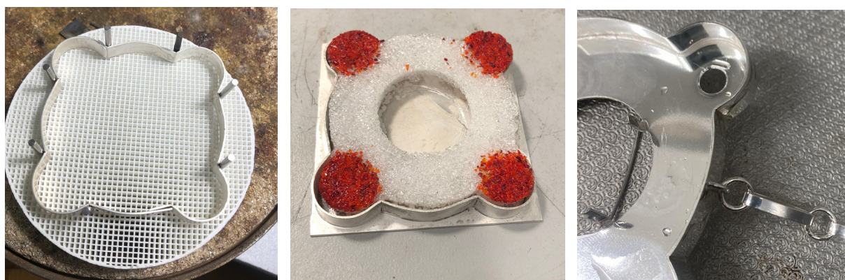
Joonis 21. Klaaspreesi kastiku vormimine, põhja sättimine ja kastik valmis preesi kinnitamiseks.
