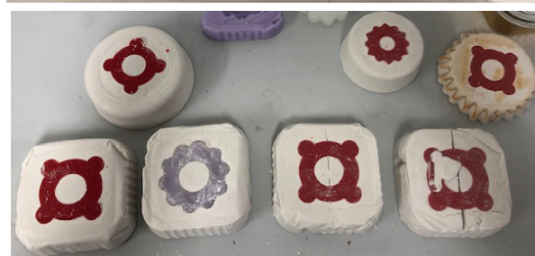
Joonis 16. Vinamoldist positiiv vormid ja kipsivalu.
