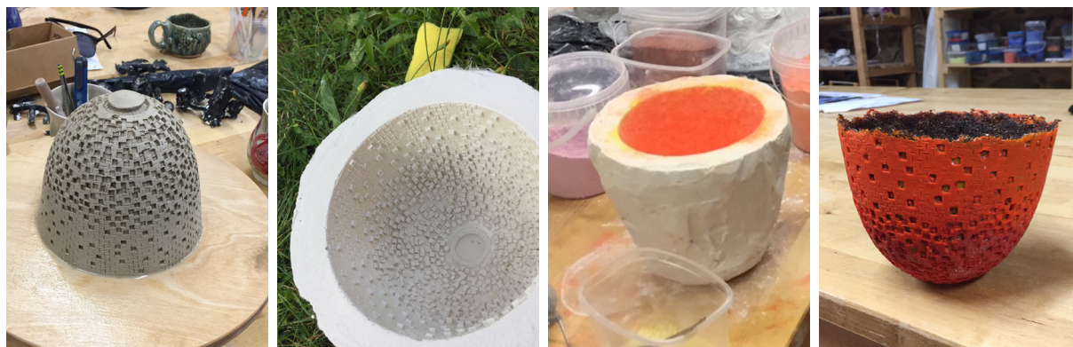
Joonis 11. Pâte de verre tehnikas lambikupli valmistamine Olustvere klaasikojas aasta 2019 suvel.
