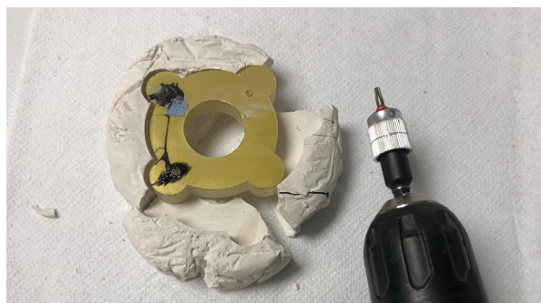
Joonis 15. Ebaõnnestunud kipsivalu.
