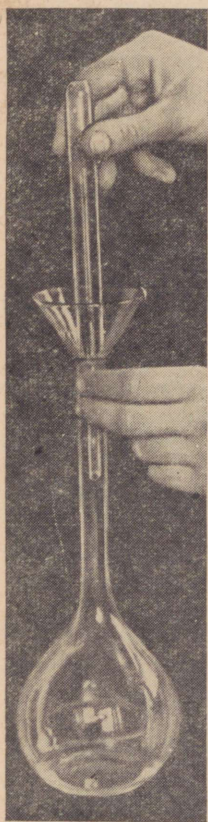
Joonis 97. Mõõtlahuse valmistamine fiksaanaalist.
