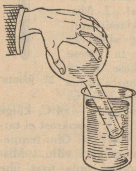
26. joonis. Õhu paisumine soojendamisel.
