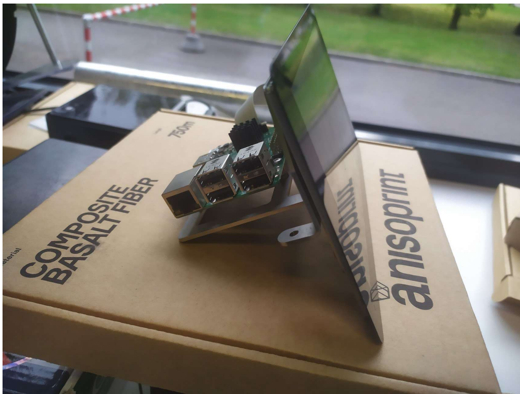
Joonis 12. Raspberry Pi 3B koos puutetundliku ekraani ja printerisse ühenduva alusega
