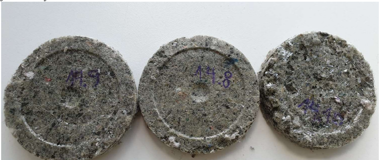
Joonis 17. Vasakul pressimata ahjus valmistatud proov. Keskel pressitud MLA proov. Paremäl pressitud ahjus valmistatud proov. Ahjus valmistatud proovid on poorsemad ja põhjakihis olev tselluvill rabedam.
