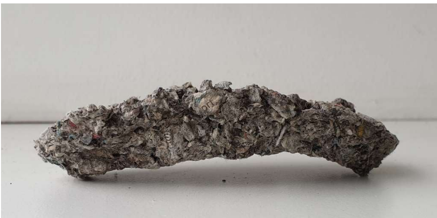
Joonis 4. Proov 25.A.6. Agar-agari baasil proov hoidis vormi ja püsis elastne enam kui kuu aega, kuid kuivas siis lühikese aja jooksul jäigaks ja kumeraks.
