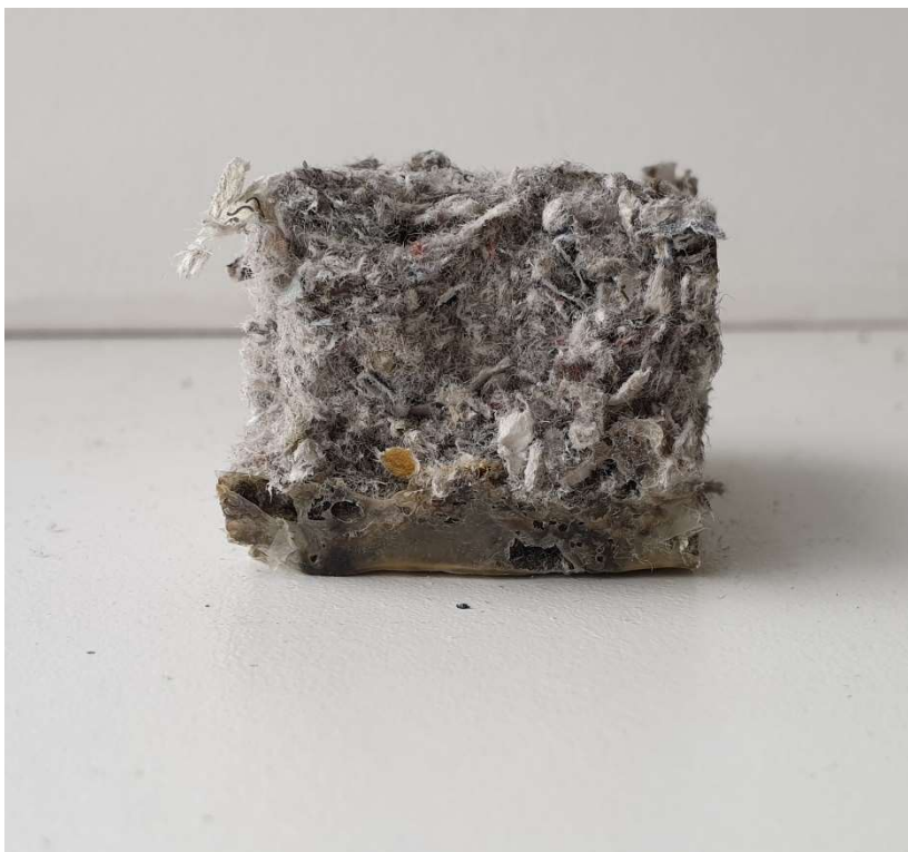
Joonis 7. Jänesnahaliimi ja tselluvilla segu. Selgelt eristub põhja vajunud liimi kiht.
