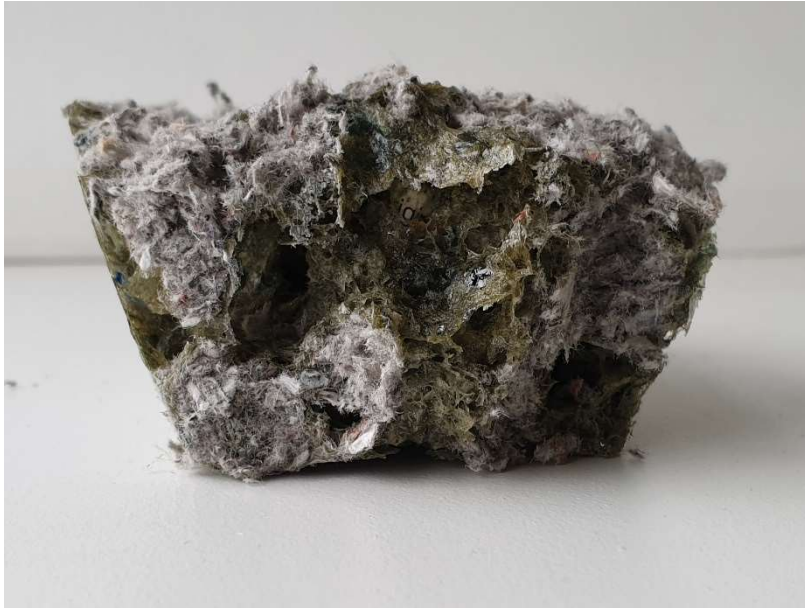
Joonis 6. Proov 20.B.6. Kõrge kondiliimi kontsentratsiooni korral läheb kondiliim keema ning moodustab jahtudes tselluvilla vahele jäiga poorse struktuuri.
