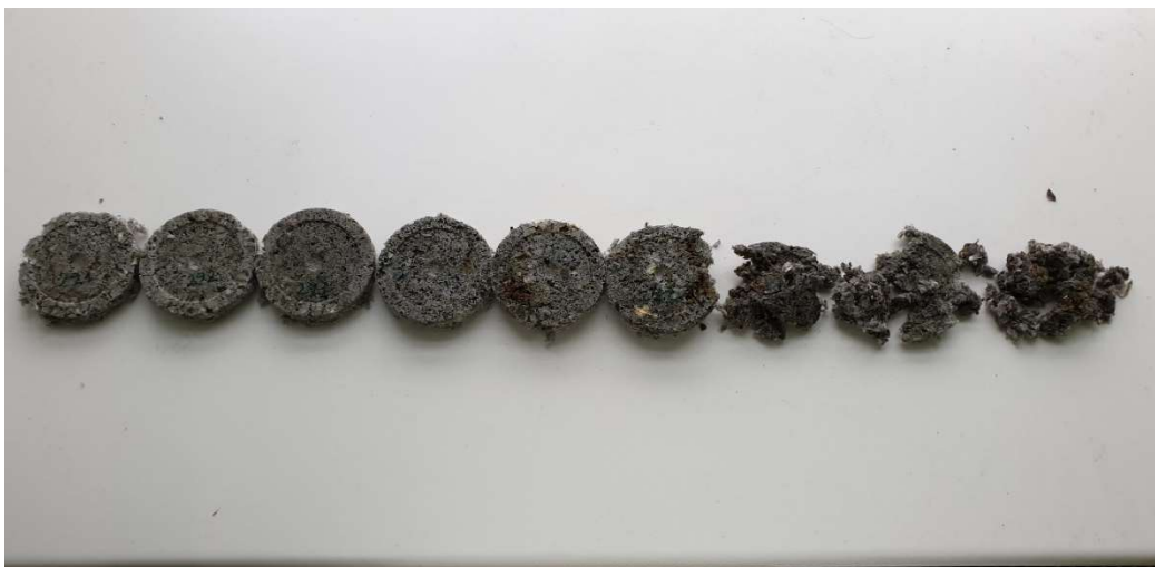
Joonis 8. Glütserooli ja vee sisalduse optimeerimine, hoides kondiliimi kogus konstantsena. Glütserooli kogus kasvab vasakult paremale 2g kaupa, 0...16g.
