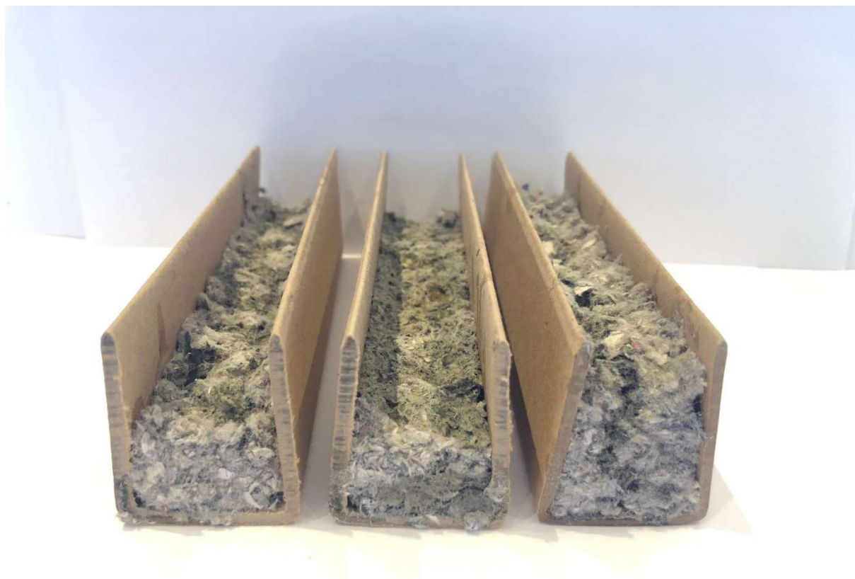
Joonis 18. Tselluvillaga täidetud pakkenurga prototüübid. Vasakul pressimata kahekihilise, keskel pressitud kahekihilise ja paremal pressimata neljakihilise pakkenurga prototüüp. Kõikides pakkenurkades on kasutatud sama kogust tselluvilla.
